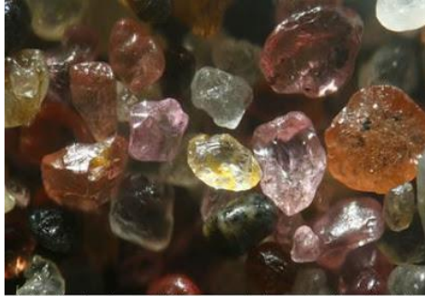
Grãos de minerais pesados de uma areia observados à lupa binocular
